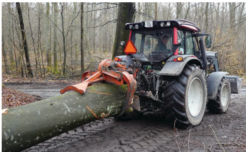
Figur 4-10. Udslæbning med hydraulisk tang monteret i traktorens trepunktsophæng.
