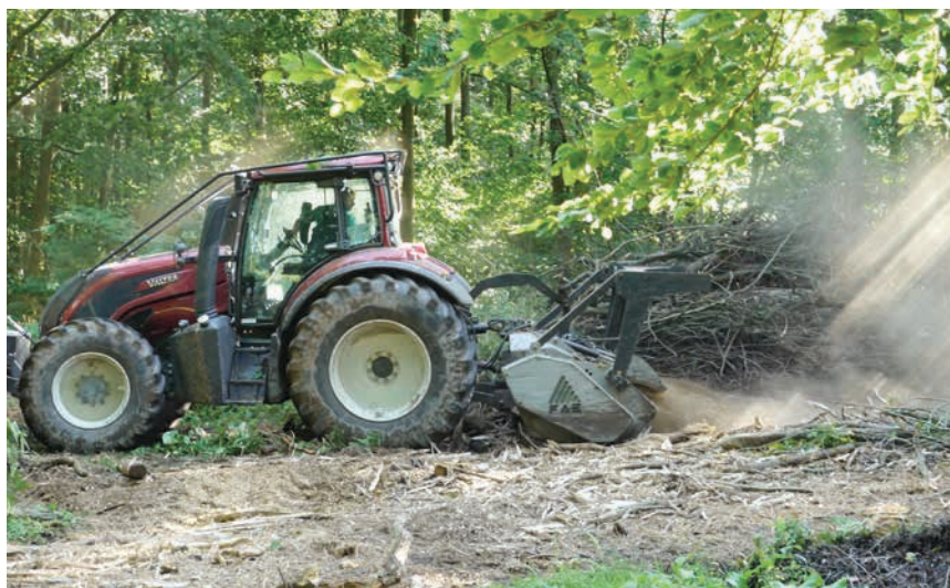
Figur 6-7. Traktormonteret grenknuser. Tromlen på knuseren har tænder af hårdmetal (lille foto).
