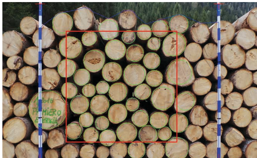
Figur 5-12. HedeDanmarks foto-opmåling. Stadierne bruges til at finde billedets målestoksforhold og dermed stakkens forsideareal. Den røde firkant og de grønne cirkler bruges til at beregne fastmasseprocenten.
