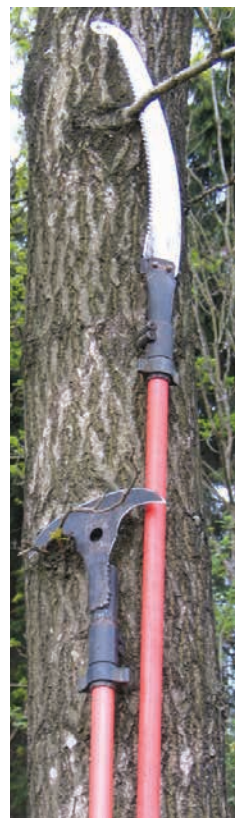
Figur 7-11. Sav til opstamning og kniv til afskæring af vanris.
