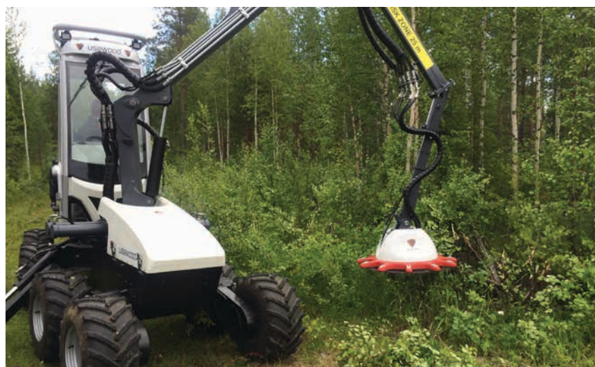
Figur 7-2. Finsk udrensningmaskine. Nederst til højre det klippende aggregat.
