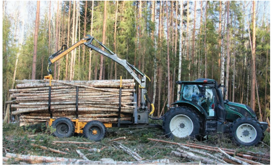
Figur 4-7. Skovvogn til brug sammen med en landbrugstraktor.
