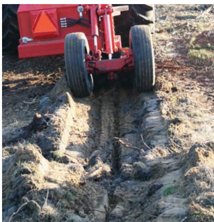
Figur 6-14. Rilleplov. Bearbejdningsresultatet ses på højre billede.
