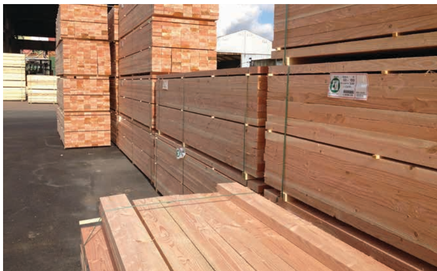
Figur 2-9. Nåletræsavværkernes vigtigste produkt er konstruktionstræ til byggeriet. Her er det 53 x 150 mm planker af douglasgran.
