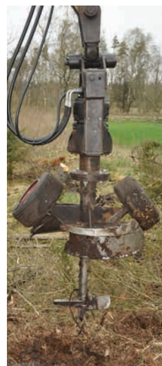
Figur 6-21. Jordbor til forberedelse af plante-huller.
