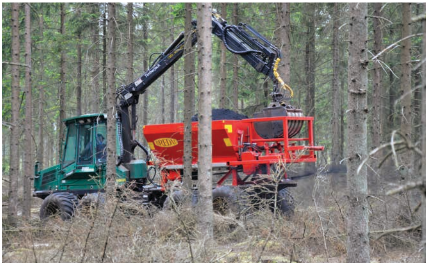
Figur 7-25. Spredning af flisaske med modificeret gødningsspreder monteret på en udkørselsmaskine.
