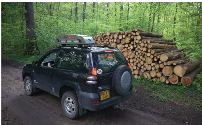
Figur 5-13. Opmålingsvogn med to video-kameraer (sScale) fra firma Dralle ApS.
