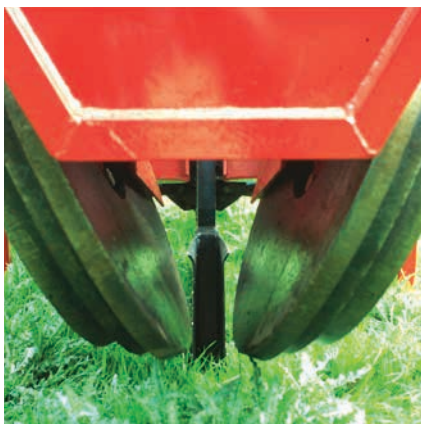
Figur 6-38. Enkel plantemaskine til montering i traktorens 3-punkts ophæng.
