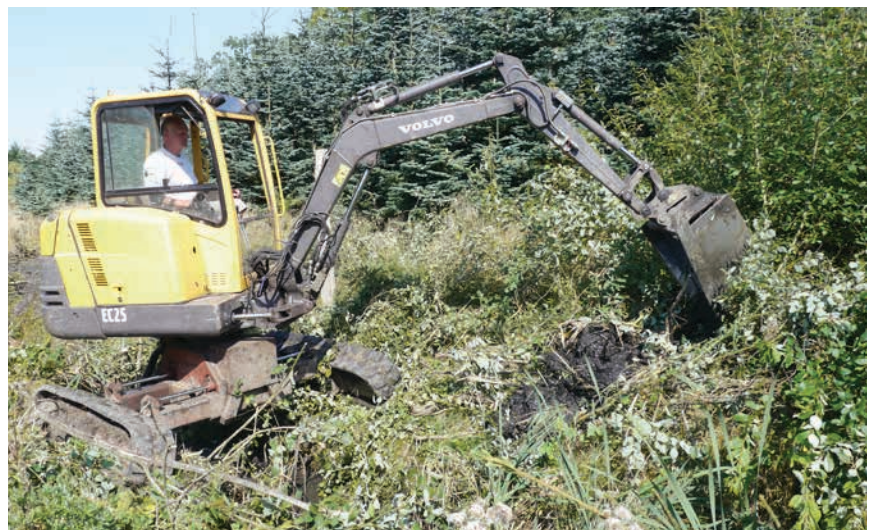
Figur 7-18. Gravemaskine, hvor bæltene kan vinkles og forskydes i bredden.
