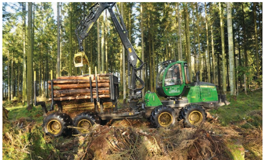
Figur 4-8. Udkørselsmaskinen er et specialbygget køretøj beregnet til terræntransport af træ. Maskinen er knækstyret, dvs. den styres ved at vinkle for- og bagvogn.
