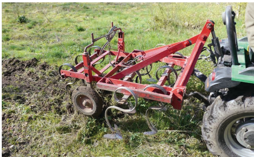
Figur 6-43. Smal radrenser med gåsefodsskær til mekanisk ukrudtsbekæmpelse.
