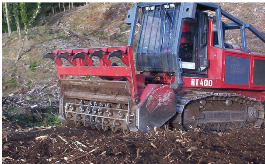
Figur 6-9. Kraftig grenknuser, som også fjerner stødene.
