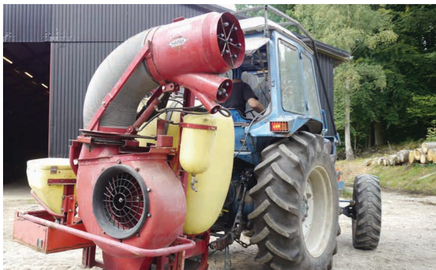
Figur 6-26. Tågesprøjte, som kan bruges til forberedende ukrudtsbekæmpelse.
