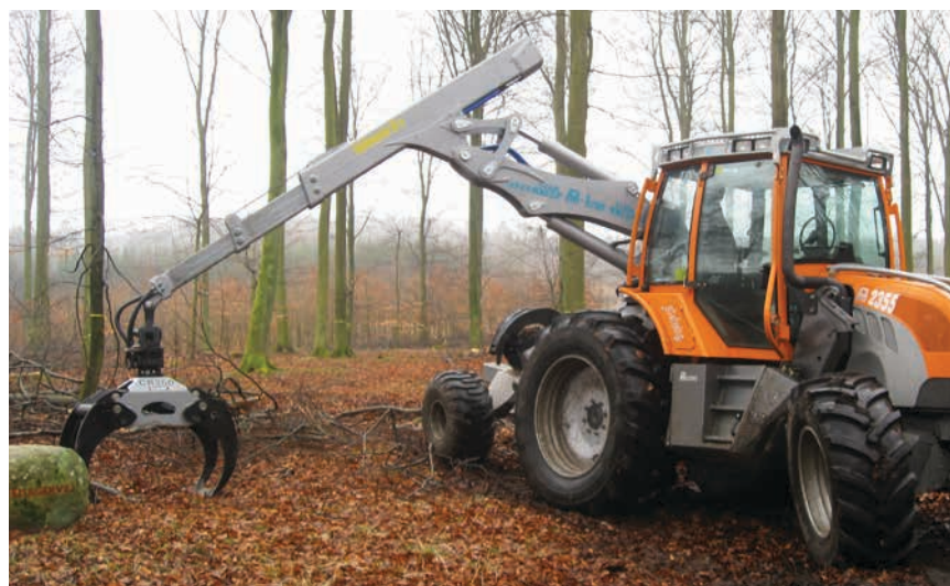
Figur 4-11. Tysk traktor med udslæbningskran. Bemærk den efterhængte vogn (sulky) med en lille klembanke. (Foto: Bo Brockmann)
