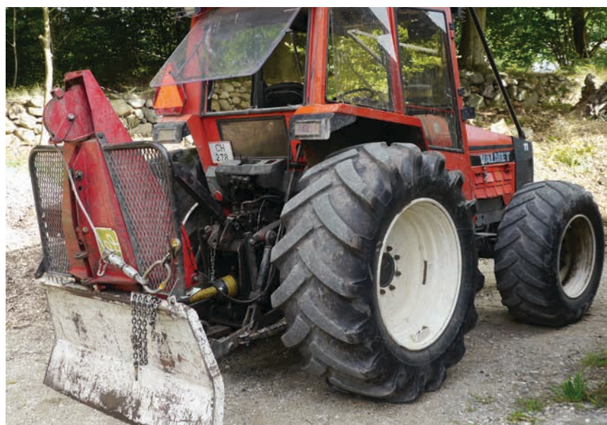
Figur 4-9. Udslæbningsspil til montering i traktorens trepunkts-ophæng.
