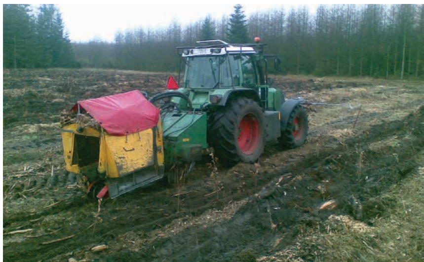
Figur 6-40. Rillepløjning og maskinplantning i én arbejdsgang. Hede-Danmarks plantnings-system.
