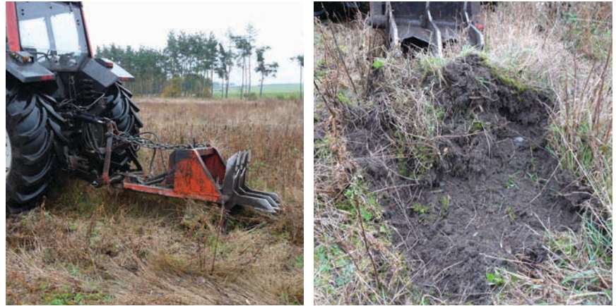
Figur 6-20. Kulla kultivator. Til højre ses bearbejdningsresultatet.
